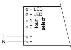
**500 mA:** Klemmen 0 und 1 verbunden mit 0 Ω Draht (max. 6 cm Länge) oder Widerstand ADV Plug Type A BR (Artikelnummer: 28001771)
